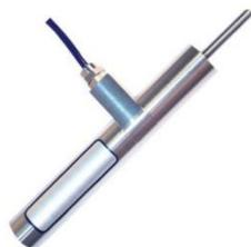
Устройство **FOD** — это оптоволоконный преобразователь линейного положения и смещений соседних поверхностей в трещинах и соединениях строительных конструкций в сооружениях из бетона, камня и металла. Датчик основан на принципе интерферометрии Фабри-Перо, и выпускается в прочном нержавеющем стальном или алюминиевом корпусе для работы в жестких условиях окружающей среды. Точный и надежный, этот прибор обладает высокой разрешением, искробезопасен и нечувствителен к ЭМП, РЧП и грозovому разряду.
