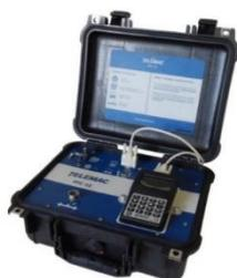
Переносной регистратор данных **PFC-12** предназначен для точного считывания и записи данных всех вибродатчиков (струнных) в режиме установившихся и затухающих колебаний. Температуру датчиков можно считывать путем измерения сопротивления катушки датчика.
