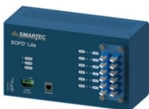
Устройство считывания **SOFO Lite** может обслуживать до 10 или 12 датчиков SOFO (интерферометрических). Датчики SOFO отличаются превосходной точностью и температурной компенсацией для работы с длинной базой. Система рассчитана на продолжительные статические измерения и контроль, в частности, конструкций гражданского строительства. Система SOFO Lite заключена в компактный корпус и допускает установку в аппаратных шкафах или в помещении.
