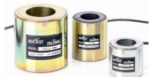
Датчик **ANCL0** представляет собой датчик нагрузки, оснащенный электроизмерительными устройствами для определения механического разрывного усилия в растяжках, анкерных болтах и штангах или усилия сжатия в конструкциях. Это устройство рассчитано на тяжелые и неблагоприятные условия окружающей среды, характерные для горнодобывающей и строительной промышленности. Датчики выпускаются либо кольцевого типа — для определения усилия разрыва, либо сплошного — для отслеживания компрессионной нагрузки.
