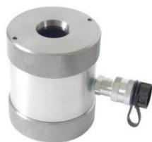
**Трехосевой датчик Хоека НТС** предназначен для определения прочности кернов по трем осям; керны горных пород или бетона получают с помощью алмазной коронки. Испытания, проведенные на серии образцов при разных давлениях сжатия позволяют пользователю определить прочностные и упругие характеристики материала, прочность на сдвиг при различных давлениях сжатия, угол сопротивления сдвигу, когезию, модуль упругости и коэффициент Пуассона.
