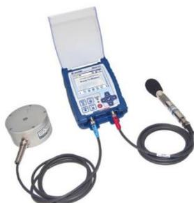
Надежный и прочный монитор вибрации **MICROMATE** позволяет осуществлять надежный мониторинг в соответствии с требованиями нормативных актов, используя для этого трехосевой геофон согласно ISEE или DIN и линейный микрофон ISEE или микрофон для регистрации уровня громкости звука. Устройство **MICROMATE** оснащено сенсорным интерфейсом. Поддержка USB 2.0 позволяет использовать карты памяти и другие внешние устройства. Его можно легко интегрировать в систему **SENSLOG**.
