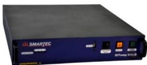
Устройство считывания DiTemp HARSH предназначено для распределенных измерений температуры на расстоянии до 12 км с пространственным разрешением 1 м и временем измерения 10 с. Имеет встроенный 4-канальный мультиплексор и представляет собой экономичное решение для распределенных измерений температуры. Это устанавливаемое в стойку устройство можно дополнять внешним релейным модулем и системой самопроверки (ATTS).
