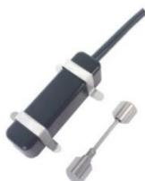
Серия **SM-2** миниатюрных струнных датчиков используется для измерения механического напряжения. Устройства SM-2 выпускаются в двух моделях: SM-2W предназначена для крепления посредством точечной сварки, а SM-2A устанавливают в высверленное отверстие в металлоконструкциях, доступ к которым затруднен.
