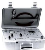
Устройство **PR-20** представляет собой портативный пневматический индикатор давления, предназначенный для считывания данных пневматических датчиков большинства изготовителей. Оно выполнено в прочном водонепроницаемом корпусе, содержащем баллон со сжатым азотом под давлением 10 000 кПа. Модель **PR-20D** проста в использовании, оснащена автоматическим регулятором расхода и высокоточным цифровым манометром.
