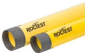
**Устройство GEO-LOK** — это корпус для инклинометра, используемый для того, чтобы прятать в нем датчики измерения боковых подвижек и деформации грунта, скальных пород и конструкций. Для соединения секций трубки не нужны клей, заклепки или расчалки. **GEO-LOK** легко разбирается и может использоваться. Выпускаются также телескопические секции. В критически важных случаях для конструкций глубокого залегания возможен обзор по спирали.
