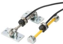
Устройство **SM-5** представляет собой накладной струнный датчик; он используется для мониторинга изменений механического напряжения, а это позволяет оценивать напряжение, если известен модуль упругости материала. Датчик устанавливают на таких конструкциях как мосты, сваи, тоннели и облицовки. Устройство выпускается в двух моделях, различающихся способом механического крепления: SM-5A крепится двумя стопорными винтами, а SM-5B — шестигранными гайками.
