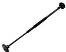
Устройство **ERI** представляет собой экстензометр засыпки, предназначенный для отслеживания вертикальных смещений между двумя точками внутри любого типа искусственных насыпок. Обычно устройство укладывается горизонтально в канавах. Его также можно установить вертикально для измерения осадки в точке контакта с фундаментом. Оно также используется для мониторинга гребня земляных насыпей с целью выявления в них трещин напряжения.
