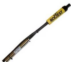
**Многоуровневый струнный пьезометр PWML** представляет собой отличный инструмент для измерения давления в порах на разной глубине в одной и той же скважине. Он легко и надежно устанавливается, так как несколько пьезометров серии PW могут быть подключены к одному и тому же кабелю связи. Размещение каждого датчика вдоль кабеля связи определяется заказчиком, так как каждый многоуровневый прибор изготавливается индивидуально.
