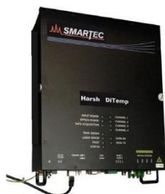
Устройство считывания DiTemp HARSH предназначено для распределенных измерений температуры на расстоянии до 12 км с пространственным разрешением 1 м и временем измерения 10 с. Устройство оснащено встроенным 4-канальным мультиплексором и может использоваться как самостоятельное устройство в суровых условиях окружающей среды. Оно потребляет мало энергии и может работать в широком интервале измеряемых температур. (Оценка SIL 1 и 2).
