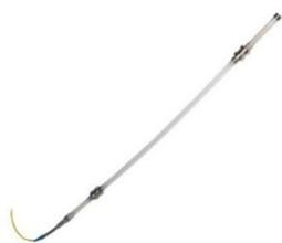
**Датчик деформации SOFO** преобразует вариации расстояния в изменение разности пути света в двух оптических волокнах, а эту величину можно измерить при помощи устройства считывания SOFO. Датчик SOFO измеряет деформацию с разрешением микрометров. Это встраиваемый или устанавливаемый на поверхности прибор, нечувствительный к температуре, коррозии и вибрации. Кроме того, он нечувствителен к ЭМП и РЧП, не требует калибровки.
