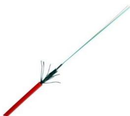
Эти кабели представляют собой армированную конструкцию в пластиковой оболочке, что обеспечивает отличные механические свойства — устойчивость к внешнему давлению, раздавливанию и повреждению грызунами; при этом благодаря малому поперечному сечению и использованию теплопроводных материалов конструкция обеспечивает также быструю реакцию на температурные изменения. Различные по конструкции кабели позволяют измерять температуру в стандартном и расширенном диапазонах.
