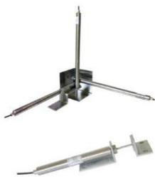
Устройство **RTF** представляет собой трещиномер, используемый для определения смещений трещин в конструкциях или скальной породе. Датчик размещается в очень прочном водостойком корпусе, на одном конце которого имеется подпружиненный стержень, упирающийся в эталонную поверхность, расположенную напротив разлома. В комплект поставки входят установочные шаблоны для одноосевого варианта (RTF 1D) или трехосевого (RTF 3D).
