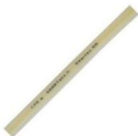
**Распределенный датчик механических напряжений DiTeSt SMARTape II** разработан для установки на гладкие поверхности или для закладки в композиты. Датчик DiTeSt SMARTape II состоит из одномодового оптического волокна, заделанного в полимерную ленту, упрочненную стекловолокном. Сама лента обеспечивает отличные механические свойства и стойкость к химическому и температурному воздействию. Небольшой размер ленты облегчает перевозку датчиков и их установку.
