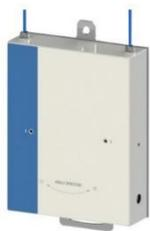
НАКЛОНОМЕР **MuST FBG** представляет собой датчик углового или линейного отклонения, работающий по принципу оптоволоконной решетки Брэгга. для измерения малых вариаций углов по отношению к вертикали и не требует температурной компенсации, так как в нем используются две решетки ВРБ в инновационной конфигурации двухтактного типа. Благодаря использованию волоконной оптики система невосприимчива к ЭМП/ РЧП и грозовому разряду.
