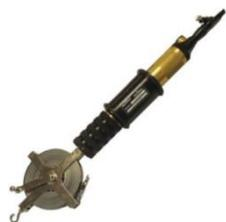
Экстензометр с рулеткой **CONVEX-D** используется для быстрого и точного измерения расстояния между двумя реперными точками. В основном он используется для мониторинга оседания в подземных выработках, таких как туннели. Он также может использоваться для мониторинга деформаций в конструкциях или для отслеживания перемещений поверхности.
