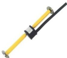
**EM** — серия заделываемых в бетон струнных датчиков. Их можно непосредственно заделывать в такие бетонные конструкции как плотины, сваи, фундаменты и мосты. Выпускаются три модели: стандартная (**EM-5**), модель для использования в массивных бетонных конструкциях (**EM-10**) и миниатюрная модель для лабораторного использования (**EM-2**).
