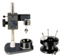
Устройство **G-200** — это аппарат с падающим конусом, используемый для быстрого и точного определения прочности на сдвиг в условиях отсутствия дренирования грунта и чувствительности глинистого грунта ненарушенного и нарушенного сложения. Система портативна, дает быстрые и точные результаты и проста в использовании. Она также используется для определения границ текучести (степени измельчения грунта).
