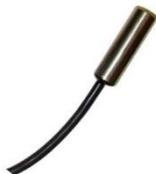
Датчик **ТН** используется для контроля температуры скальной породы, бетона, почвы или цементующего раствора. Идеально подходит для мониторинга плотин, мостов, зданий и облицовки туннелей. Обеспечивает надежный метод контроля воздействия температуры на приборы. Прочная конструкция позволяет заделывать прибор непосредственно в свежий бетон или в цементующий раствор скважины. В качестве чувствительного элемента используется 3-килоомный чип-термистор, платиновый резистор, или термопара.
