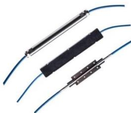
Температурный датчик **MuST FBG** представляет собой искробезопасное устройство, предназначенное для заделки или установки на поверхности. Эти датчики являются волоконно-оптическими вариантами обычных датчиков температуры, но полностью пассивными, с присущей им исходной нечувствительностью к дрейфу. Кроме того, эти датчики нечувствительны к искровому разряду, ЭМП/ РЧП и грозовому разряду.
