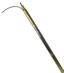
**BOREMAC** — это самозабуривающийся прессиометр, используемый для определения свойств мелкодисперсных почв в полевых условиях. Он состоит из модуля дезинтегратора (буровая головка и башмак), защищенного металлическими ребрами расширяемого зонда и адаптера, соединяющего зонд с внешней штангой стандартного размера EW. Внешние штанги используются для погружения и извлечения зонда. Внутренние штанги служат для вращения режущих элементов и для подачи бурового раствора.
