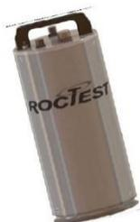
В **серию SL** входят разнообразные конфигурируемые модули интерфейса, предназначенные для чтения данных с электрических датчиков и (или) вибродатчиков, располагающихся в скважине. Они выпускаются в беспроводном варианте с питанием от батареи с длительным сроком службы. Модульный принцип, водонепроницаемая конструкция и прочная антенна делают их идеальными для применения во влажной атмосфере.
