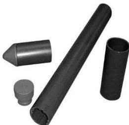
**Устройство GTI-1A<sup>1</sup>** — это корпус для инклинометра, используемый для того, чтобы прятать в нем датчики измерения боковых подвижек и деформации грунта, скальных пород и конструкций. Муфты собираются при помощи склеивания растворителем и сажаются на заклепки. В критически важных случаях для конструкций глубокого залегания возможен обзор по спирали.
