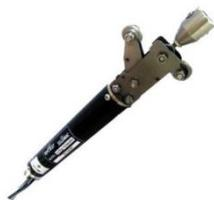
Устройство **PISA-M** представляет собой устанавливаемый на месте инклинометр, используемый для автономного измерения бокового смещения почв, каменной породы и конструкций, таких как плотины, подпорные стенки и тоннели. Устройство PISA-M использует датчик MEMS, который отслеживает отклонение либо по одной, либо по двум осям, а также оснащен встроенной функцией нормирования сигнала. Этот IPI устанавливается в последовательной конфигурации, и к одному кабелю можно подключить до 50 датчиков.
