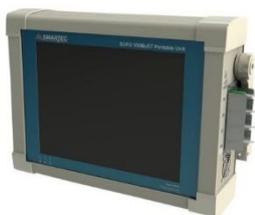
**Переносное устройство считывания данных SOFO VII MuST** позволяет вести измерения по 4 каналам. К каждому каналу можно подключить до 5 датчиков SOFO (нужен внешний разветвитель 1 x 5) и от 7 до 25 датчиков MuST. Устройство содержит ПК, который обеспечивает регистрацию данных и функции дистанционного интерфейса.
