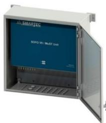
Устройство считывания SOFO VII/ Must способно осуществлять считывание со всех датчиков SOFO и MuST. Каждый из 4 или 8 каналов можно использовать для считывания с датчиков SOFO или MuST (FBG). В состав устройства входит ПК для дистанционного конфигурирования и регистрации данных. Устройство выполнено в компактном стальном корпусе, предназначенном для постоянной установки на месте, что удобно при необходимости продолжительного непрерывного статического контроля конструкции.
