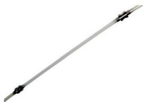
**Датчик деформации MuST FBG** превращает статическое или динамическое изменение расстояния в изменение длины волны отраженного света в предварительно напряженной оптоволоконной решетке Брэгга. Эти датчики с длинной базой допускают установку на поверхности или заделку в бетон и позволяют измерять статические или динамические деформации. Они нечувствительны к коррозии и **невосприимчивы** к ЭМП и РЧП. Для компенсации температуры можно предусматривать дополнительный датчик.
