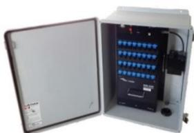
Устройство FODL-1600/ 3200 представляет собой уникальный регистратор данных, предназначенный для применений, в которых требуется непрерывный мониторинг большого количества волоконно-оптических датчиков. Он полностью совместим с волоконно-оптическими преобразователями Фабри-Перо. FODL-1600/ 3200 выпускается в версиях с 16 или 32 каналами, корпус NEMA 4X. FODL-1600/ 3200 может сохранять до 50 000 выборок (дискретных или усредненных).
