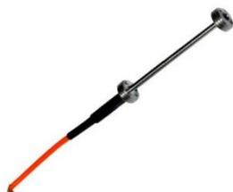
**EFO** — это волоконно-оптический датчик механических напряжений, предназначенный для заделки в бетон. Его можно закладывать непосредственно во влажную смесь или сначала залить в бетонный блок, который затем закладывается в свежую смесь. Искробезопасный, позволяет выполнять статические и динамические измерения; кварцевое волокно отличается малой чувствительностью к температуре и проводит сигналы на большие расстояния без помех вследствие изгиба кабеля.
