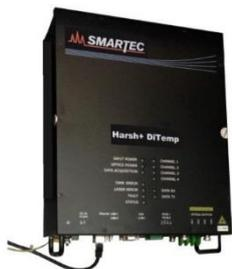
Устройство считывания DiTemp HARSH+ поставляется со встроенным ПК. Оно предназначено для распределенных измерений температуры на расстояниях до 30 км с пространственным разрешением 1 м и временем измерения 10 с. Устройство оснащено встроенным 4-канальным мультиплексором и может использоваться как самостоятельное устройство в суровых условиях окружающей среды. Оно потребляет мало энергии и может работать в широком интервале измеряемых температур. (Оценка SIL 1 и 2).
