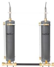
Устройство **NIVOLIC SG** предназначено для измерения относительного оседания в многоточечной системе. Оно состоит из серии камер, связанных жидкостной линией. Одна из камер используется в качестве опорной для расчета относительного смещения всех других камер. Типичные варианты применения — фундаменты плотины, отклонение мостов, строительные колонны и плиты перекрытий.
