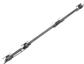
Устройство **BOF-EX** представляет собой дифференциальный скважинный экстензометр. В отличие от стержневых экстензометров, жесткие трубные секции наружным диаметром 32 мм предотвращают возможный изгиб и трение между стержнями. Тепловое воздействие значительно снижено, поскольку температура в скважине менее склонна к колебаниям. Каждый измерительный модуль помещается внутри скважины вблизи якоря. Выпускается с разными типами стержней и анкеров.
