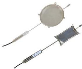
Устройство TPC представляет собой датчик для определения полного давления, состоящий из заполненного маслом герметического блока, соединенного с преобразователем давления. Оно используется для измерения общего давления в почве и насыпях, для измерения напряжений в бетоне или для измерения контактного давления подпорных стенок, насыпей и облицовки тоннелей.
