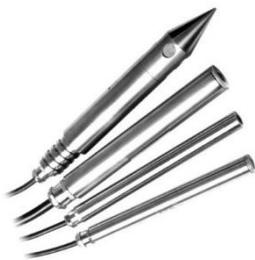
Устройство **FOP** — это волоконно-оптический пьезометр, предназначенный для измерения давления воды или другой жидкости в порах. Он используется при мониторинге гидравлических конструкций, фундаментов, плотин, насыпей и полигонов захоронения отходов. Устройство имеет прочный корпус из нержавеющей стали и пригодно для работы в суровых условиях окружающей среды. Точное и надежное, оно искробезопасно и не подвержено влиянию ЭМП, РЧП и грозových разрядов.
