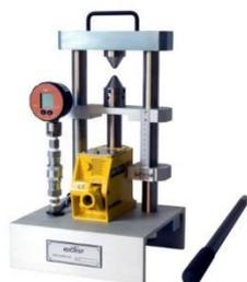
**PIL-7** — это устройство, предназначенное для определения показателя прочности при точечном нагружении. Этот показатель позволяет классифицировать породы по прочности. PIL-7 — это прочная система с армированным экраном для защиты от разлета осколков в случае поломки. Она портативная и имеет прочную конструкцию с коническими рабочими поверхностями.
