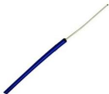
**ДАТЧИК МЕХАНИЧЕСКОГО НАПРЯЖЕНИЯ ПЭНД** рекомендуется для широкого диапазона приложений, которые требуют распределенного детектирования механических напряжений, таких как отслеживание подвижек почвы и мониторинг грунта. Датчик механического напряжения *DiTeSt HDPE* — это небольшой гибкий волоконно-оптический чувствительный кабель с мини-армированием, одним оптическим волокном в центральной трубке, металлическими армирующими проволоками и наружной оболочкой из ПЭНД.
