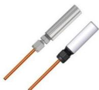
Волоконно-оптический датчик температуры **FOT-T** упаковывается либо в корпус из нержавеющей стали длиной 51 мм, либо в корпус из ПВХ. Он искробезопасен, невосприимчив к ЭМП, РЧП и грозовому разряду. Корпус из ПВХ специально рекомендуется для работы в морской воде.
