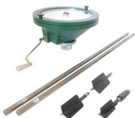
Прибор **M1000** для испытания грунта в скважине представляет собой прецизионный полевое средство измерений, состоящее из головки регистрации крутящего момента, буровых штанг, специально сконструированных лопаток и скользящей муфты. Головка измеряет и записывает сопротивление лопаток, трение буровой штанги и угол поворота. Несущей конструкцией системы служит скважинный адаптер головки регистрации крутящего момента.
