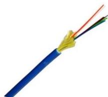
**ДАТЧИК HYDRO И GEO** измеряет распределение механического напряжения и температуры и рекомендуется для закладки в почву и бетон или для вшивания в геотекстиль. Кабель круглого сечения содержит 4 одномодовых и 2 резервирующих многомодовых оптических волокна для использования со устройствами считывания *DiTeSt* и *DiTemp* с целью распределенного контроля механических напряжений и температуры, соответственно.
