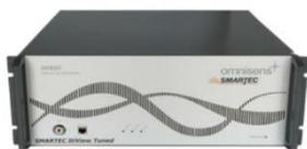
Устройство считывания **DiTeSt DUAL** представляет собой уникальное устройство для оценки распределенного напряжения и (или) температуры на расстоянии в десятки километров с возможностью измерений в тысячах точек при помощи одного оптического волокна. Система DiTeSt имеет 4 канала с быстрым и точным измерением механического напряжения и температуры на расстоянии до 50 км в режиме BOTDA и до 45 км с помощью измерений методом BOTDR в волокне с одним концом без зеркала.
