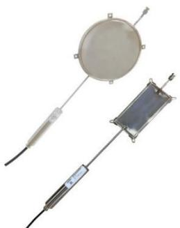
Устройство **TPC** представляет собой датчик для определения полного давления: заполненный маслом герметичный блок, соединенный с преобразователем давления. Оно используется для измерения общего давления в почве и насыпях, для измерения напряжений в бетоне или для измерения контактного давления подпорных стенок, насыпей и облицовки тоннелей.
