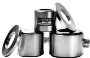
Устройство **VH** представляет собой нагрузочный вибродатчик, предназначенный для измерения нагрузки в растяжках, анкерах фундаментов, штангах и опорах тоннелей. Это устройство рассчитано на работу в тяжелых и неблагоприятных условиях окружающей среды, характерных для горнодобывающей и строительной промышленности. Датчики выпускаются либо кольцевого типа — для определения нагрузки на разрыв, либо сплошного — для отслеживания компрессионной нагрузки.
