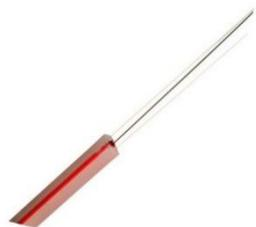
Этот **распределенный датчик механических напряжений DiTeSt SMARTProfile** предназначен для заделки в бетон и почву, а также для установки на неровные поверхности или в углубления. Оптимальное резервирование достигается тем, что кабель содержит два свободных и два связанных одномодовых оптических волокна, заделанных в полиэтиленовый термопластический прямоугольный профиль. Связанные волокна измеряют механическое напряжение, а свободные служат для температурной компенсации.
