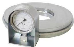
**HYDLO** — это гидравлический датчик нагрузки, предназначенный для непосредственных измерений нагрузки на растяжки, анкерные болты и штанги, а также для измерений компрессионных нагрузок в конструкциях. Выполнен из двух пластин, сваренных друг с другом по периферии, и заполненных деаэрированным маслом. Эта конструкция также применяется для контроля состояния анкерных болтов и штанг, применяемых в шахтах и для стабилизации склонов.
