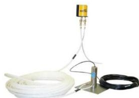
Устройство **SSG** — это датчик для измерения оседания или поднятия почвы в определенных местах. Устройство **SSG** состоит из струнного или волоконно-оптического первичного преобразователя напряжения, размещенного в устойчивом к коррозии корпусе из нержавеющей стали. Устойчивый и прочный, этот корпус позволяет размещать устройство в скважинах, стояках, почве или цементе. Датчик оседания также можно крепить к конструкциям для мониторинга их оседания.
