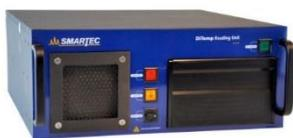
Устройство считывания DiTemp HARSH предназначено для распределенных измерений температуры на расстоянии до 12 км с пространственным разрешением 1 м и временем измерения 10 с. Выпускается в мультимодовом и одномодовом варианте. Устройство допускает установку в стойке и может быть оснащено внешними мультиплексорами (на 4, 8 и 16 каналов), релейным модулем и системой самопроверки (ATTS). (Оценка SIL 1 и 2).
