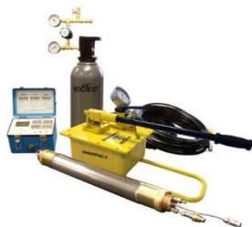
Устройство **TRI-MOD-S** — это прессиометр, используемый для определения в полевых условиях прочностных характеристик жестких почв и мягких горных пород. В отличие от других прессиометров это устройство позволяет проводить испытания при давлении до 20 000 кПа. Устройство измеряет изменения диаметра и допускает анизотропические измерения.
