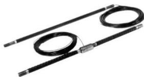
**АРМАТУРНЫЙ СТЕРЖЕНЬ СО СРЕДСТВОМ ИЗМЕРЕНИЙ** — это арматурный стержень, в который встроен струнный датчик механического напряжения. Устройство используется для измерения нагрузки и деформации в таких бетонных конструкциях как плотины, фундаменты, сваи и облицовка тоннеля. Такие стержни можно использовать как парные к существующим и встраивать их в систему арматуры или заливать цементом в скважине в качестве крепи.
