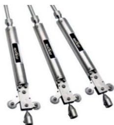
Встраиваемая инклинометрическая система **HORIZON-M** состоит из корпуса инклинометра и цепочки инклинометрических датчиков. Корпус инклинометра, который контролирует ориентацию датчиков, устанавливается в канаве или в горизонтальной скважине с одним набором желобков, ориентированных вертикально. Датчики измеряют отклонение корпуса (наклон относительно горизонтали). Изменения в величине отклонения указывают на то, что корпус сместился под действием подвижки грунта.
