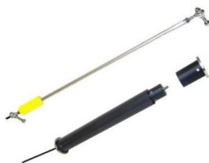
Устройство **JM** представляет собой преобразователь деформаций, используемый для мониторинга смещения между слоями бетона в бетонных плотинах. Очень прочная конструкция представляет собой струнный вибродатчик внутри телескопического корпуса из нержавеющей стали. Легко устанавливаемое, очень устойчивое и надежное устройство также используется для мониторинга отделения торкрета от поверхности породы на стенках тоннелей, а также для определения перемещений трещин и соединений в конструкциях.
