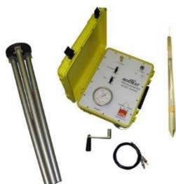
Прессиометр **PENCEL** — это очень мобильное испытательное устройство, простое в эксплуатации и экономичное. Зонд устанавливают непосредственно на месте — динамически вбивая или статически вдавливая в почву. Затем зонд нагружают гидравлическим способом (сжатый газ не требуется). Полный зонд **PENCEL** можно использовать в сочетании с конусом.
