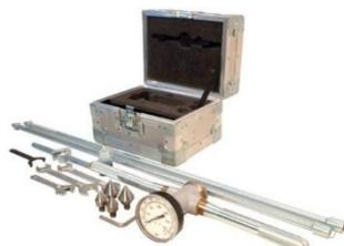
Ручной статический пенетрометр **HSA-5** был разработан для зондирования почв на ограниченных глубинах методом так называемого «голландского конуса» (статическая пенетрометрия) с применением одной колонны штанг.
