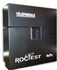
Устройство **RXTx** представляет собой станцию дистанционного считывания показаний, используемую для мониторинга относительных горизонтальных и вертикальных смещений между струной прямого или обратного маятника и конструкцией. Устройство оптически измеряет относительное положение струны маятника вдоль осей x и y при смещениях в теле плотин, оснований и в других конструкциях.
