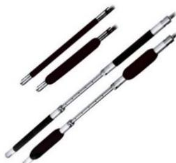
Опрессовочные пакеры **LP и MP** используются для блокирования или изоляции определенных зон в скважине. Втулка выполняется из армированной резины и может иметь разный диаметр. Типичные применения включают испытания проницаемости, заливку цементным раствором под давлением в трещиноватых или неконсолидированных пластах, впрыск воды и контроль поступления метана в шахтах.
