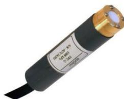
Пневматический пьезометр **FPC-2** измеряет давление жидкости в почве, а также на границах раздела с подземными сооружениями или вблизи них. Устройства FPC-2 изготавливаются из бронзы или из нержавеющей стали и рассчитаны как на краткосрочное, так и на длительное использование. Устройства FPC-2 могут быть оснащены впускными фильтрами из расчета на малое или высокое содержание воздуха. Устройство выпускается в двух моделях: FPC-2 для установки в скважину и FPC-2D для заглубления в мягкую почву.
